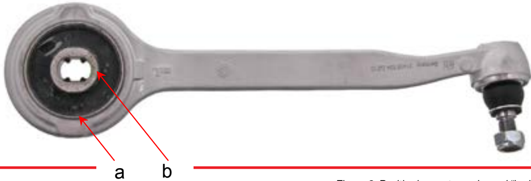
Figura 3: Poziția de montare a bușei „hydro-mount”
