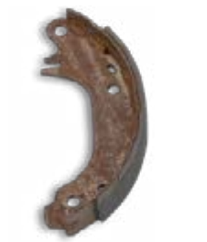
sabot de frână cu tambur fără strat de protecție după 48 h de încercare în ceață salină
