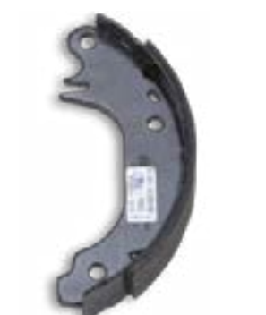
sabot de frână cu tambur original ATE cu strat de protecție după 48 h de încercare în ceață salină
