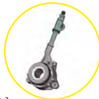
Fig. 2: Cilindru concentric receptor prevăzut cu supapă purjare pe traseul hidraulic
