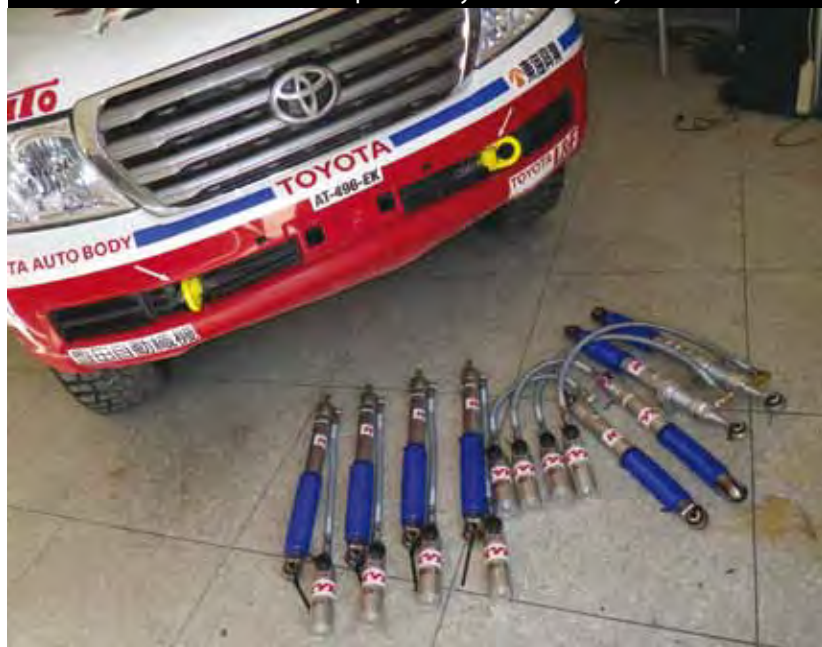
Amortizoarele KYB dezvoltate pentru Toyota Autobody
