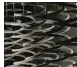
Fig. 5 Arcurile elicoidale sunt vopsite printr-un proces de acoperire cu pulberi epoxidice.
