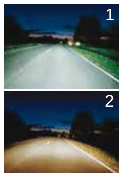
1 Distribuția luminii și culorii tipice unui bec xenon. (fig. 1) 2 Distribuția luminii și a culorii, tipic becurilor cu halogen. (fig. 2)
