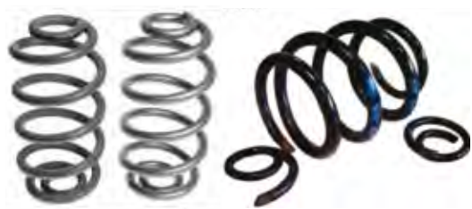
Fig. 1. Arc rupt prematur, la ambele capete
