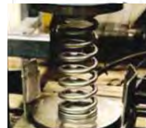
Fig. 3 Operația de pre-setare implică comprimarea arcului pentru aplicarea unei presiuni reziduale pozitive.
