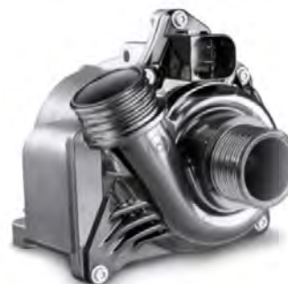
Pompa de apă electrică Ruville fără curea este acționată de curentul mașinii de 12 volți
